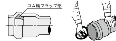
**3** そのまま受口のゴム輪溝の位置に入れ、ゆっくりと手をゆるめてゴム輪を装着します。ゴム輪が正しく装着されたかどうかを必ず確認し、ねじれやずれがあれば修正してください。
